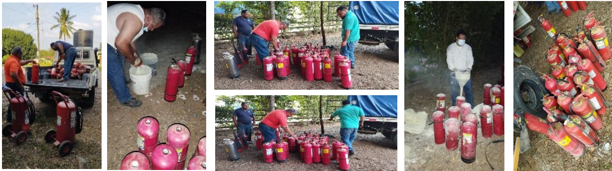
Ilustración 29: Proceso de relleno de extintores 2025
